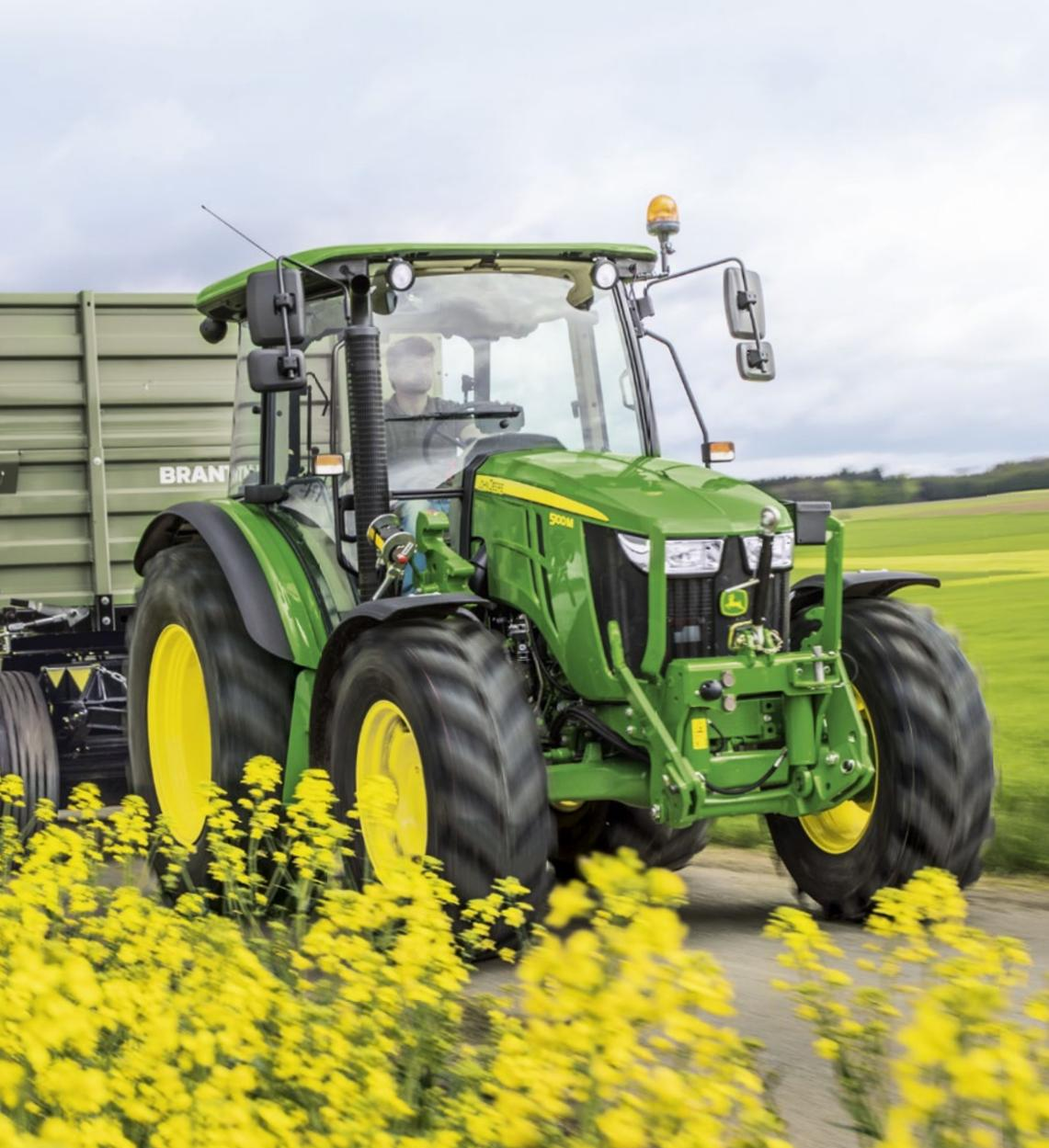
Aucun additif n'est requis : l'association de la technologie de recirculation des gaz d'échappement (EGR) refroidis, d'un échangeur air/air et d'un filtre à particules diesel (DPF) suffit à assurer la conformité aux normes d'émissions Stage III B.
